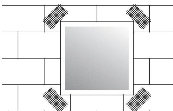
Da bi sprečili eventualnu pojavu dijagonalnih pukotina na uglovima otvora, pre početka armiranja celokupne fasadne površine potrebno je izvršiti prethodno armiranje po uglovima otvora. Armiranje se vrši pomoću komada fasadne mrežice okvirne veličine min. 30x50 cm koji se postavljuju dijagonalno uz sam ugao otvora. Pripremljeni komad mrežice se polaže u sloj svežeg lepka namenjenog za armiranje, nanetog nazubljenom gletericom (veličina zuba ~ 8-10 mm).
