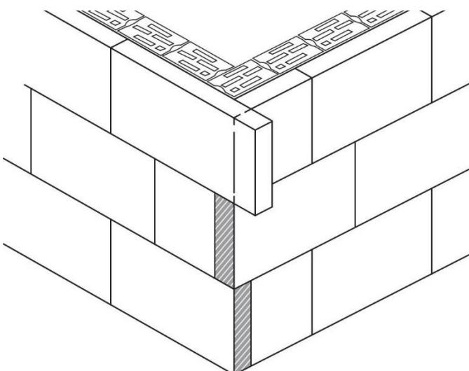
Ploče lepiti tesno jednu uz drugu tako da lepak ne dospeva na kontaktne površine između dve MW ploče. Eventualne pukotine zapuniti komadićima MW ploče ili niskoekspandirajućom pur penom zatvuštenim BK-PUR EPS Kleber Gun, a nikako lepkom.
